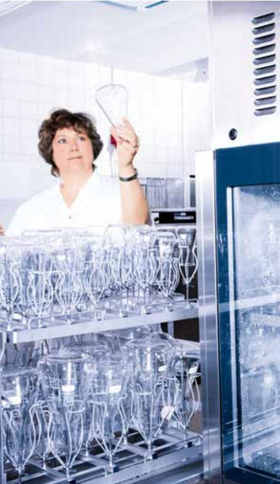
Inspección visual del vidrio de laboratorio tras el reprocesamiento mecánico
