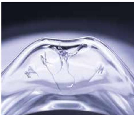
Fisuras en el pico de un vaso de laboratorio
