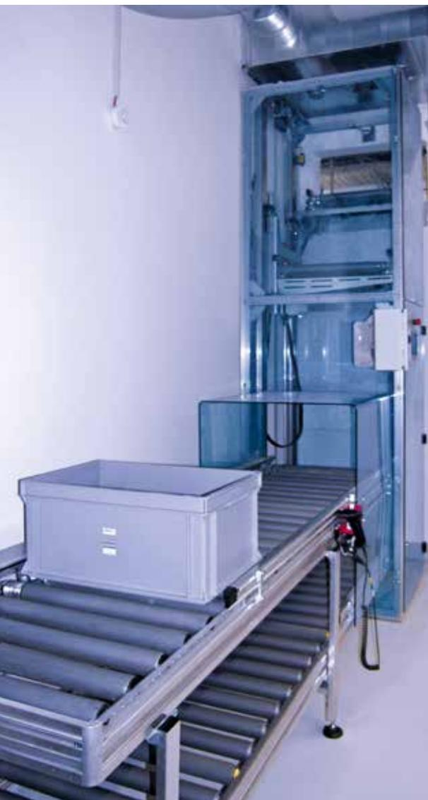
Zona de salida de un sistema de transporte en cajas
