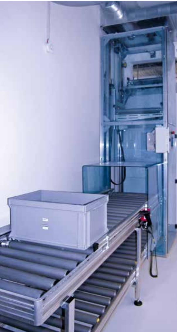
Écoulement système de transport à caissons
